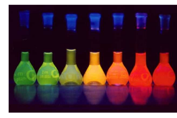
Fluoreszenz unterschiedlich großer CdTe-Nanopartikel
